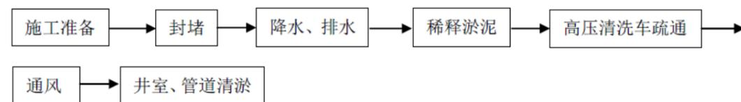
①施工准备：了解排水管道管径、管道走向、管道高程，划分清淤分段，选择合适的封堵及清淤方案。对施工场地进行围挡，围挡高度不小于1.8m，设施安全色标和警告牌，施工范围内设置警告区，限速慢行，并设置醒目路障，禁止非施工人员进入现场，每个作业井口外侧由1名安全人员值守，防止行人掉入检查井内。
