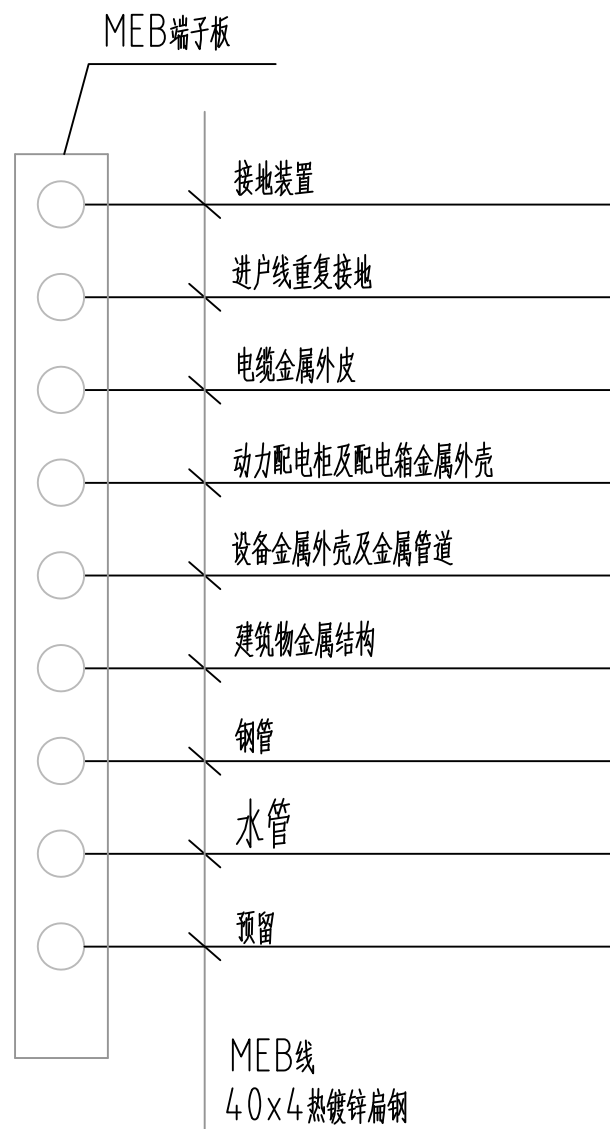
MEB总等电位联结示意图
