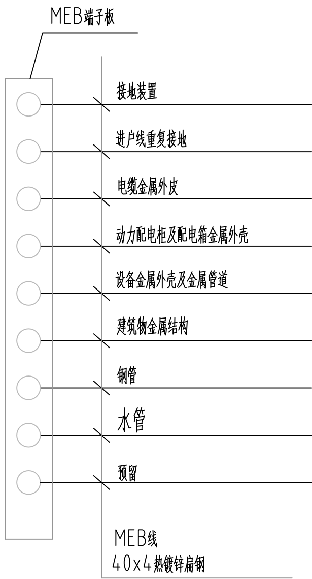
MEB总等电位联结示意图
